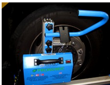
Håndtaget monteret i masten
